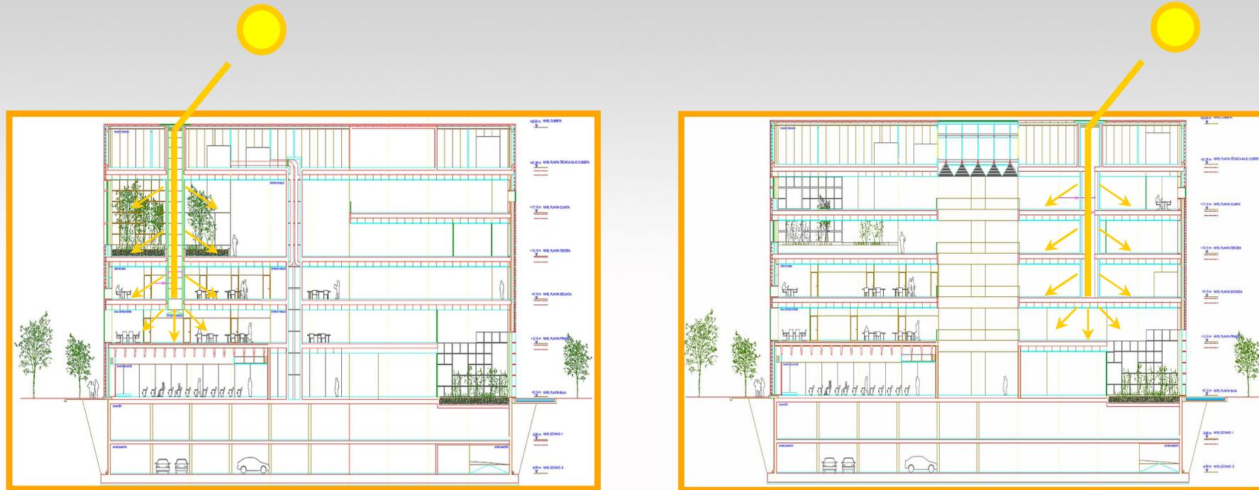
1. Captación de la luz solar en la cubierta
