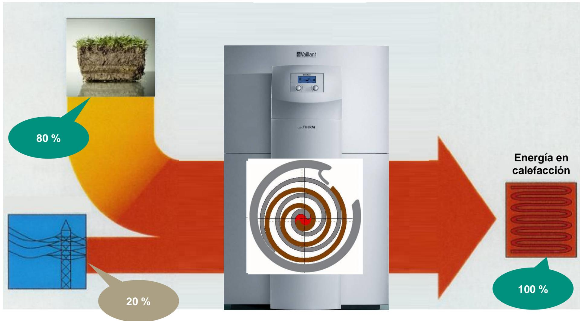
La bomba de calor potencia el efecto térmico de la energía del ambiente
